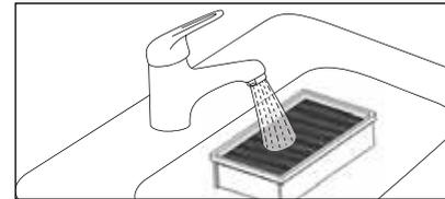
**3.** Beim Absaugen unterschiedlicher Schmutzarten verstopft der Filter irgendwann und die Saugkraft nimmt ab. Reinigen Sie den Filter deshalb regelmäßig unter laufendem Wasser und lassen Sie ihn trocknen.
