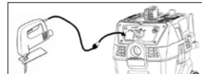
Stecken Sie das Netzanschlusskabel des Elektrowerkzeuges in die am Sauger dafür vorgesehene Buchse ein.
