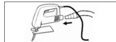
Bringen Sie den konischen Adapter am Elektrowerkzeug an.
