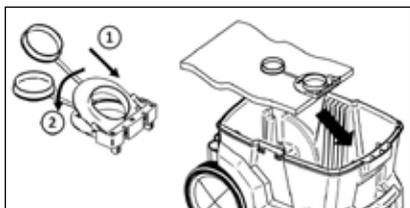
1. Öffnen Sie den Staubbeutel, indem Sie die Kappe von der Öffnung herunter klappen. An der Öffnung des Staubbeutels stehen drei Kanten ab, die sich in die Aussparungen am Sammelbehälter einhaken müssen.
