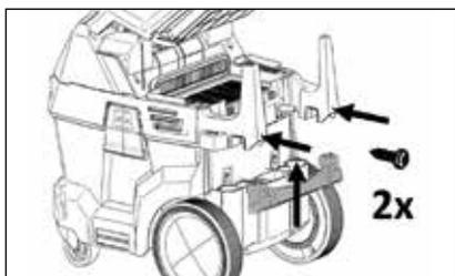
4. Bringen Sie anschließend den Steg mit zwei Kreuzschlitzschrauben an den beiden Haltern an. Der Steg sorgt für eine höhere Stabilität und Robustheit. Schließen Sie anschließend den Filterdeckel.
