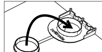
2. Wenn der Staubbeutel voll ist, entfernen Sie ihn in gleicher Weise und schließen Sie den Einlass des Staubbeutels mit dem Deckel.
