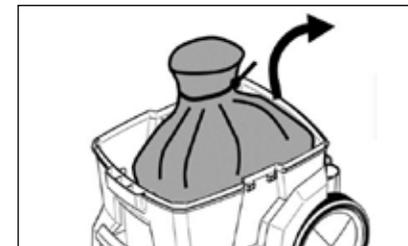
2. Wenn der Beutel voll ist schließen Sie ihn mit dem Kabelbinder, der dem Beutel beiliegt.
