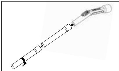
Stecken Sie anschließend das Saugrohr zusammen und stecken Sie dieses an das Handrohr an.
