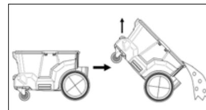
Um Staub/Schmutz aus dem Behälter zu entleeren, nehmen Sie den Kopf des Geräts ab (siehe Kapitel "Inbetriebnahme"). Wenn Sie einen Staubbeutel oder Abfallbeutel verwenden, entfernen Sie den Beutel und legen Sie einen neuen ein.
