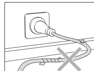
**⚠️ GEFAHR** Netzanschlusskabel nur in einwandfreiem Zustand verwenden! Netzanschlusskabel nicht beschädigen (zerren, quetschen, überfahren, ...) oder unsachgemäß reparieren. Netzanschlusskabel nicht knicken und nicht über scharfe Kanten ziehen.
