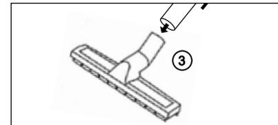
Stecken Sie die Düse für den gewünschten Reinigungszweck an das Saugrohr an (3).
