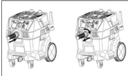
Setzen Sie das breitere Schlauchende in den Saugeinlass des Gerätes ein. Um den Schlauch zu entfernen, drehen und ziehen Sie ihn (in einer Bewegung) aus dem Gerät heraus.
