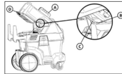
5. Schließen Sie den Filterdeckel: Den Deckel am Filterdeckelgriff (D) oder am Handgriff (A) mit einer Hand anheben. Heben Sie die Stange (C) vorsichtig mit einer anderen Hand über den Rückhaltehaken (B) und senken Sie den Deckel langsam ab. Wenn die Stange (C) über dem Rückhaltehaken (B) liegt, nehmen Sie die Hand von der Stange (C) und schließen Sie den Filterdeckel.
