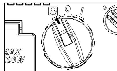
Stellen Sie den Drehknopf auf die Position Einschaltautomatik (Steckdosen-Symbol). Der Sauger läuft nun an, sobald das Elektrowerkzeug eingeschaltet wird. Wird das Elektrowerkzeug ausgeschaltet, stoppt auch der Sauger mit einer Verzögerung. In der Verzögerungszeit wird der Saugschlauch geleert.
