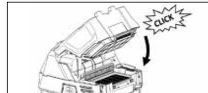
**4.** Setzen Sie den getrockneten Filter wieder in das Gerät ein und schließen Sie den Filterdeckel wieder, wie unten beschrieben.
