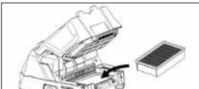
**2.** Stellen Sie vor dem Betrieb des Gerätes sicher, dass ein sauberer Filter eingesetzt ist. Nach Entnahme aus dem originalverpackten Karton ist bereits ein Filter im Industriestaubsauger verbaut.
