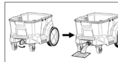
Um den Flüssigkeitsbehälter zu leeren, drehen Sie den Ablassstopfen heraus und entfernen Sie ihn. Nun kann die Flüssigkeit aus dem Behälter fließen. Trocknen Sie den Behälter mit einem sauberen Reinigungstuch nach, dass er für den nächsten Einsatz bereit ist.
