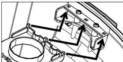
Setzen Sie dafür den Staubbeutel mit den Haken nach oben etwas gekippt (1) an und drücken Sie dann den Staubbeutel in eine waagrechte Position (2).
