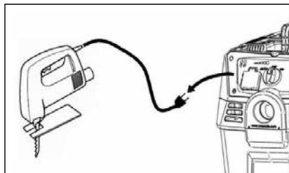
Falls Sie mit dem Elektrowerkzeug gearbeitet haben, schalten Sie dieses aus und trennen Sie erst dann den Netzstecker vom Sauger. Dies beugt einem unkontrollierten Anlaufen des Elektrowerkzeugs vor.
