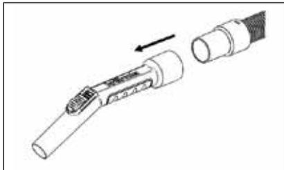
Stecken Sie zuerst die Schlauchöffnung in das Handrohr.
