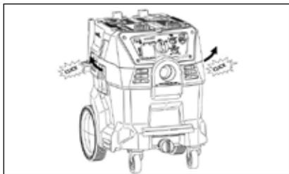
Nehmen Sie zum Einsetzen des Staubbeutels den Kopf ab. Ziehen Sie hierfür die Klemmen mit etwas Kraft nach außen und heben Sie den Kopf am Handgriff ab.
